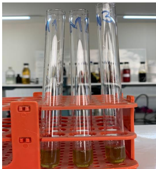
Foto 4. Teste para detecção de compostos fenólicos. Fonte: Autoral, 2025.
