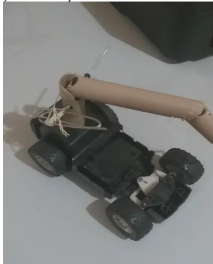
Imagem 1. Chassi do ROVER (base) com o braço mecânico instalado.
