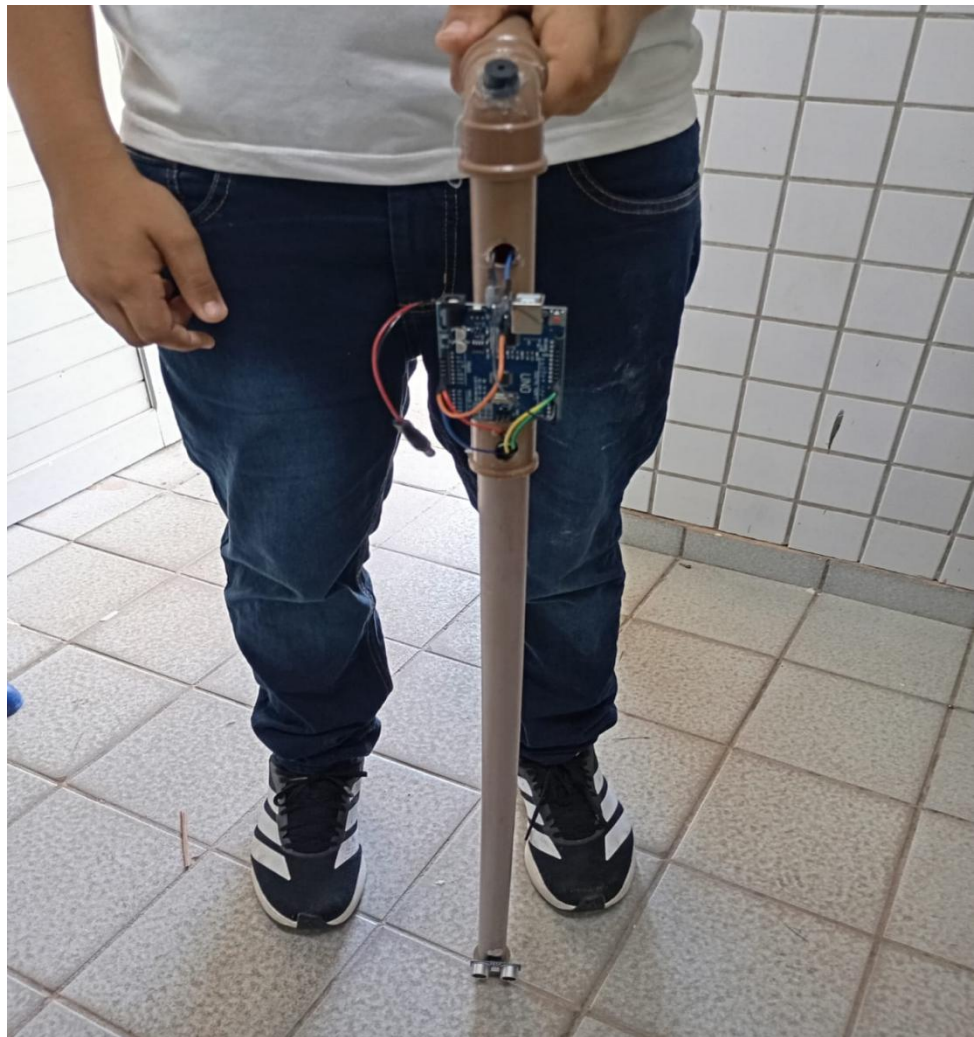
Figura 03– Teste inicial do protótipo da Bengala Inteligente utilizando Arduino Uno e componentes eletrônicos.
