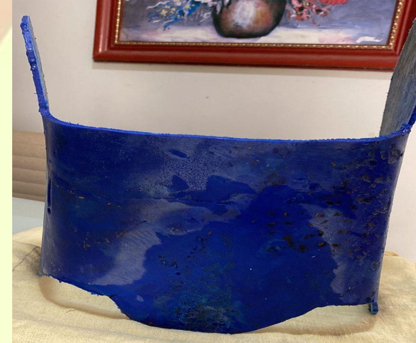
Figura 08- Protótipo do Colete feito em PEAD .
