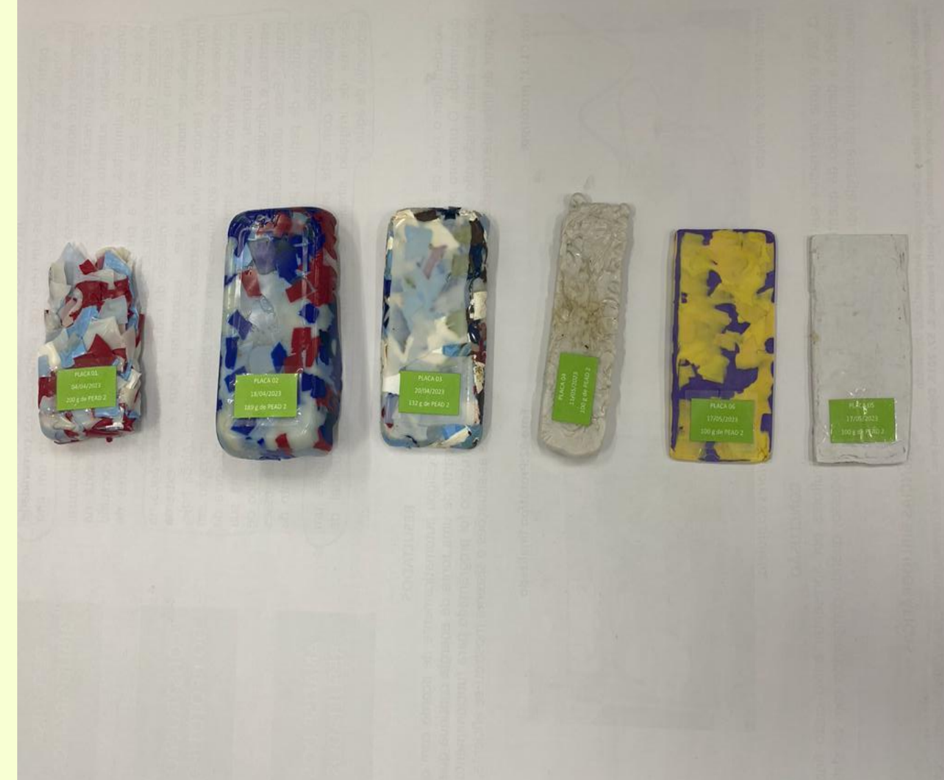
Figura 01- Placas obtidas a partir de PEAD 2 reciclado.
