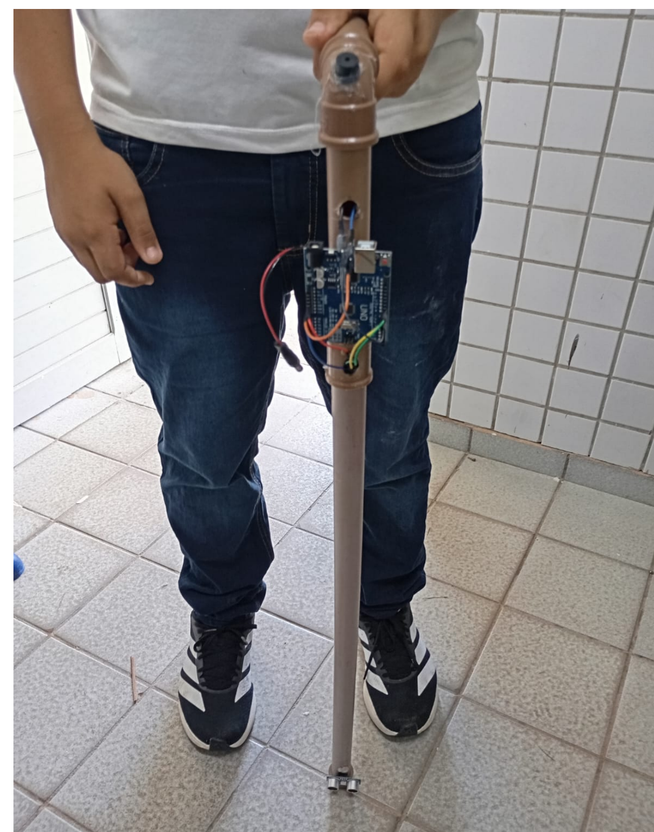
Figura 4 – Protótipo da bengala inteligente utilizado para testes de detecção de obstáculos.
