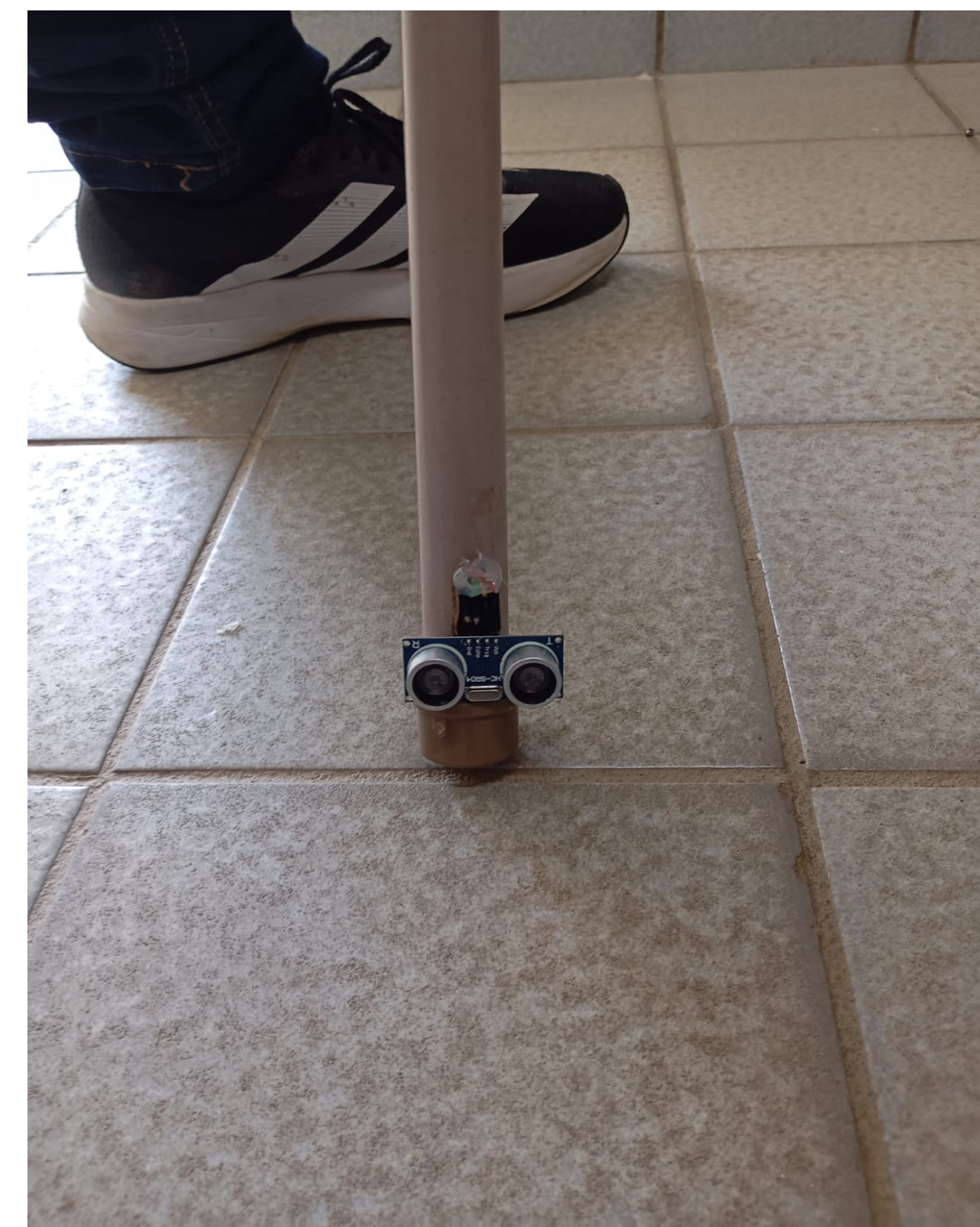
Figura 4 – Protótipo da bengala inteligente utilizado para testes de detecção de obstáculos.
